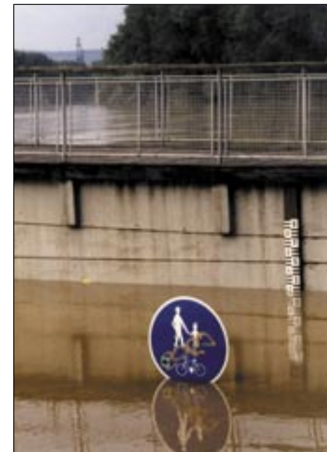
Vodočetná lat na lávce – při normálním průtoku (11. 8.) Tatáž lat při kulminaci (14. 8. 2002)
